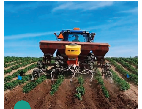
Semoir APV sur renchaussageur pour semis des cultures de couverture en intercalaire
